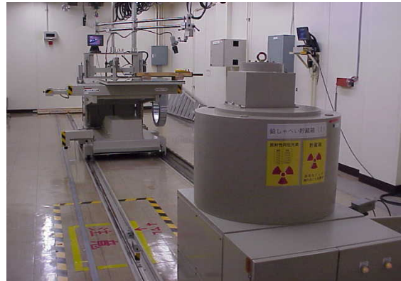
照射装置 (Co-60線源) の外観 サーベイメータ等の校正及び特性試験の実習に 使用する照射装置 (線源貯蔵) の外観を示す。
