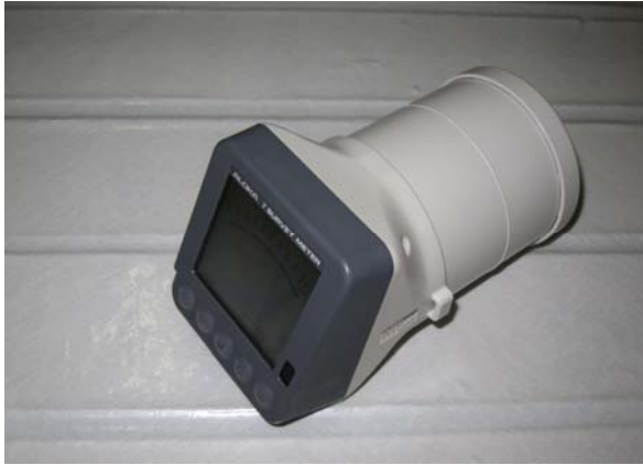
⑤電離箱サーベイメータ 装置の外観を示す。
